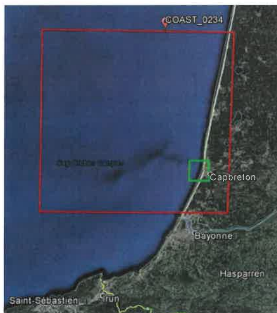
Figure 8. Système d'emboîtement des grilles de calcul (polygones rouge et vert) du modèle numérique de propagation de vague.
