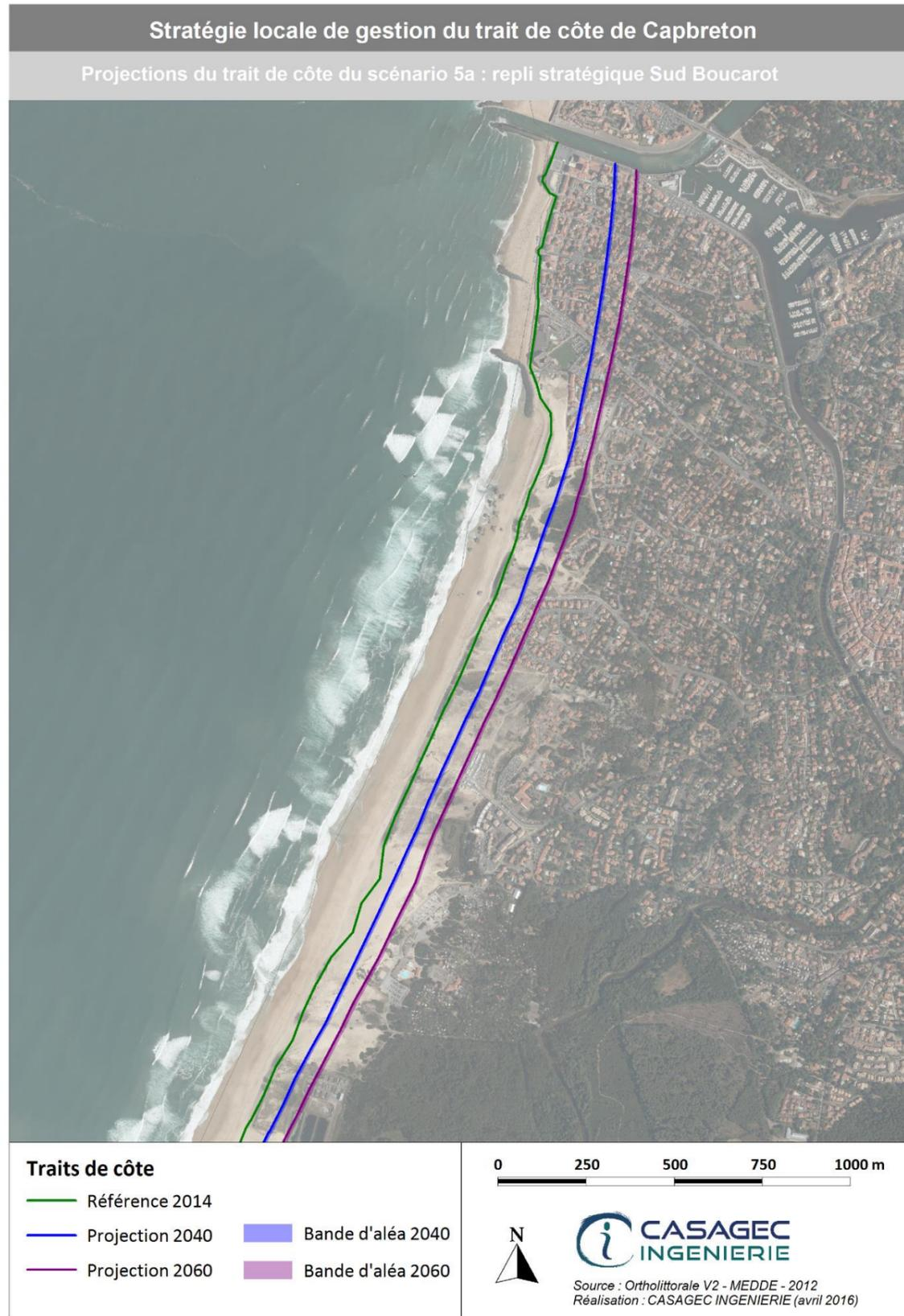
Figure 42. Projection du trait de côte aux horizons 2040 et 2060 pour le scénario 5a. Secteur Capbreton.
