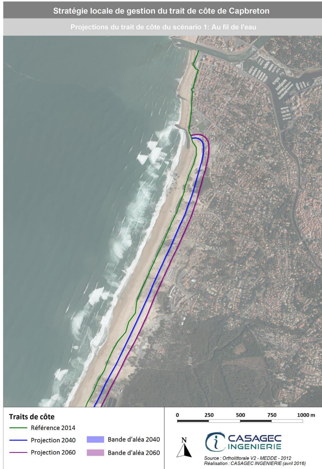
Figure 21. Projection du trait de côte aux horizons 2040 et 2060 pour le scénario 1. Secteur Capbreton.
