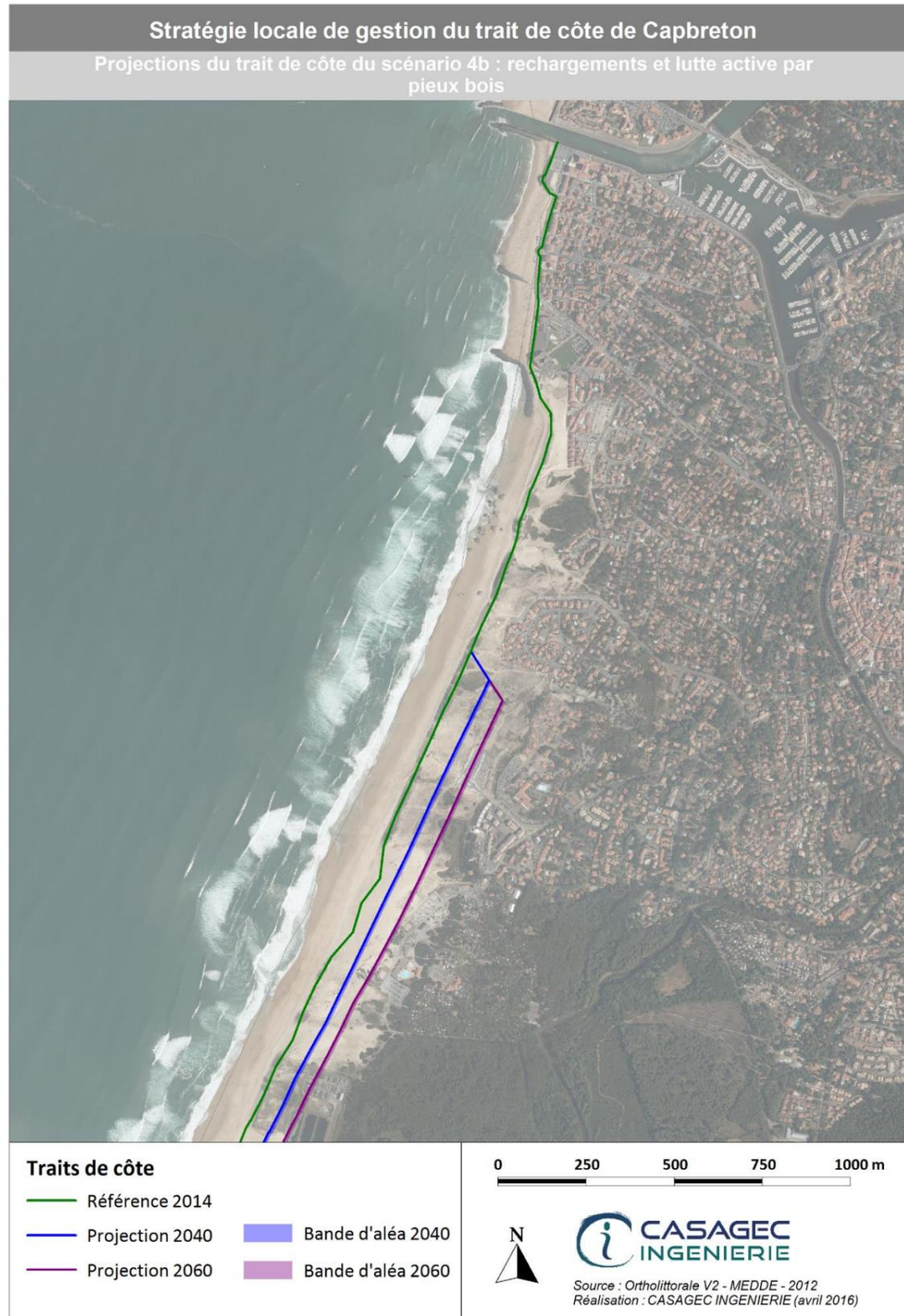
Figure 36. Projection du trait de côte aux horizons 2040 et 2060 pour le scénario 4b. Secteur Capbreton.
