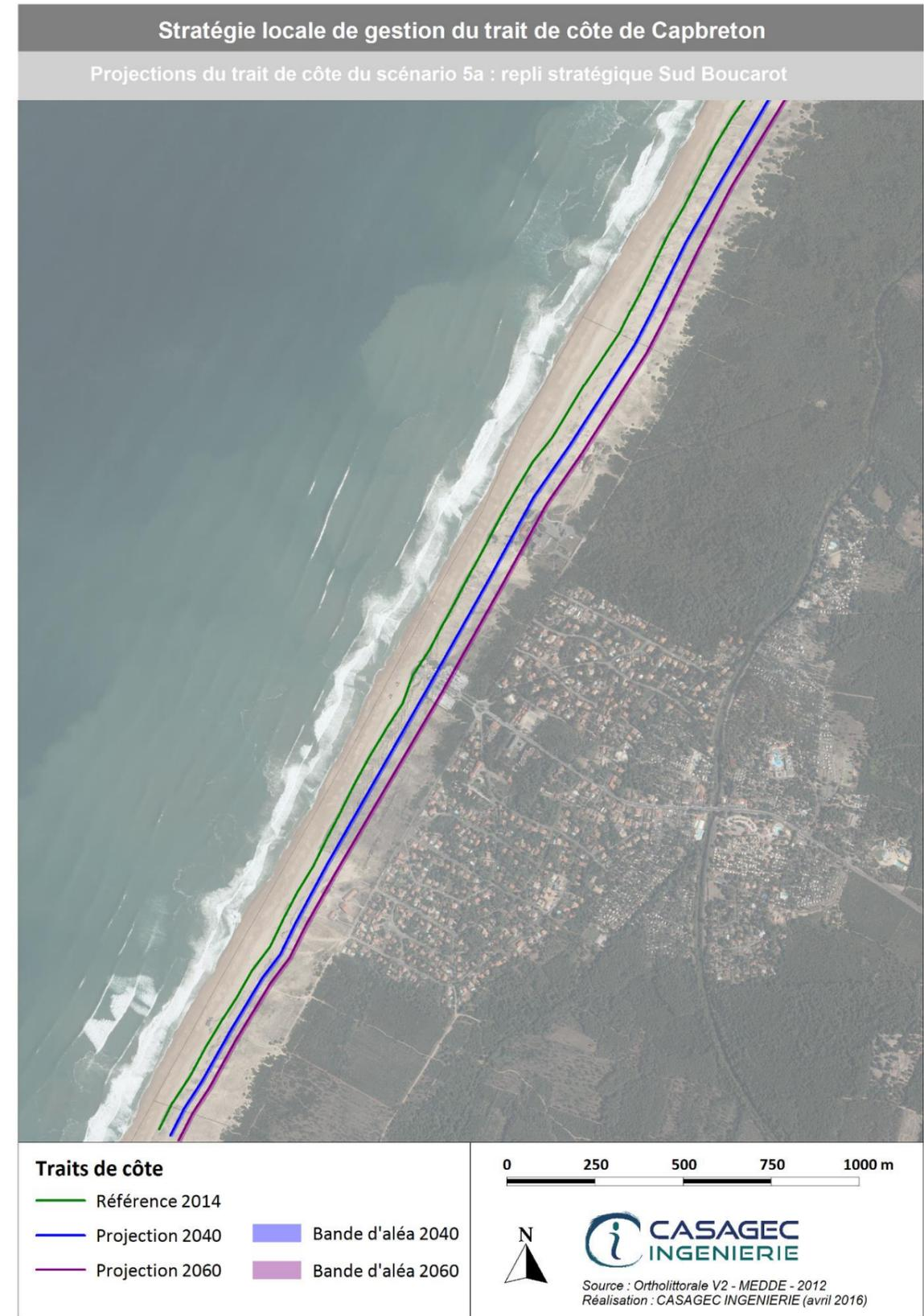
Figure 43. Projection du trait de côte aux horizons 2040 et 2060 pour le scénario 5a. Secteur Labenne.
