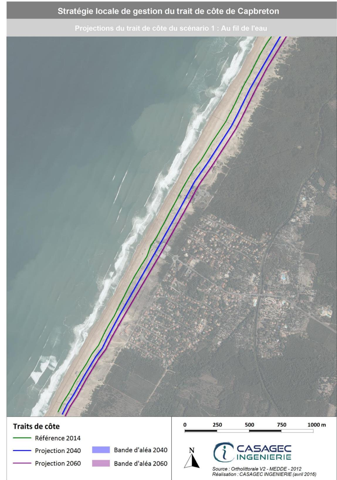
Figure 22. Projection du trait de côte aux horizons 2040 et 2060 pour le scénario 1. Secteur Labenne.
