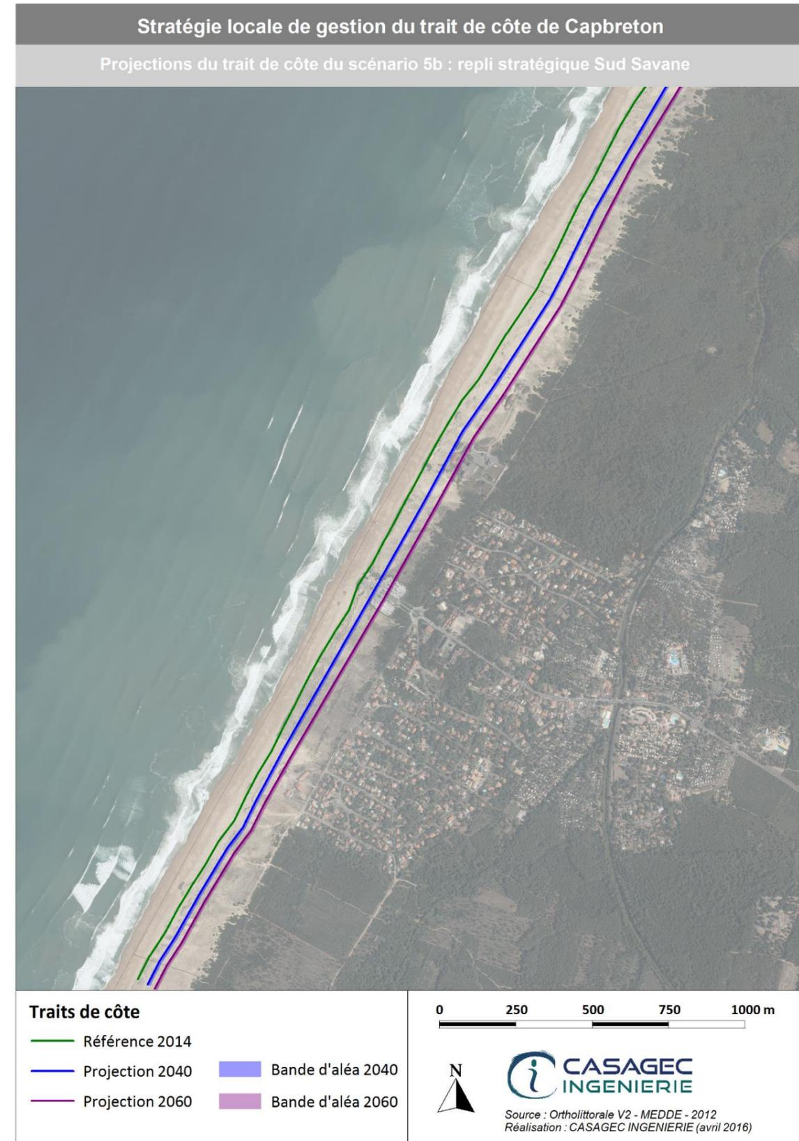
Figure 46. Projection du trait de côte aux horizons 2040 et 2060 pour le scénario 5b. Secteur Labenne.
