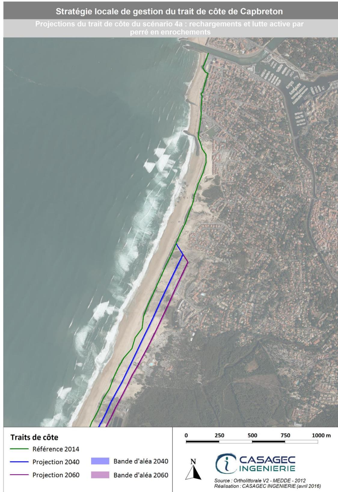
Figure 33. Projection du trait de côte aux horizons 2040 et 2060 pour le scénario 4a. Secteur Capbreton.
