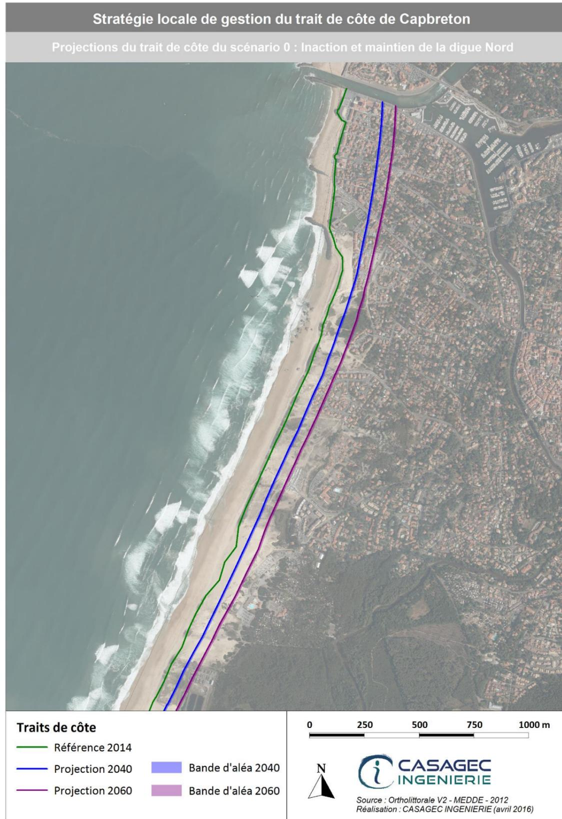
Figure 18. Projection du trait de côte aux horizons 2040 et 2060 pour le scénario 0. Secteur Capbreton.
