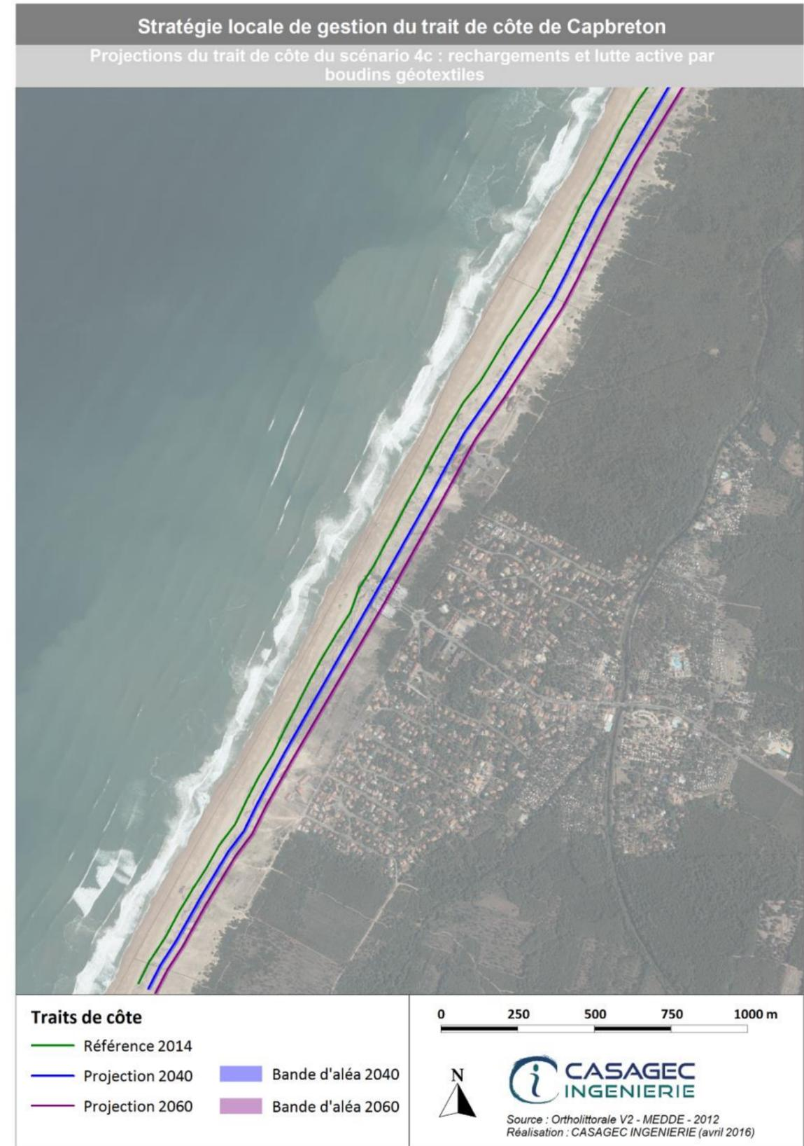
Figure 40. Projection du trait de côte aux horizons 2040 et 2060 pour le scénario 4c. Secteur Labenne.
