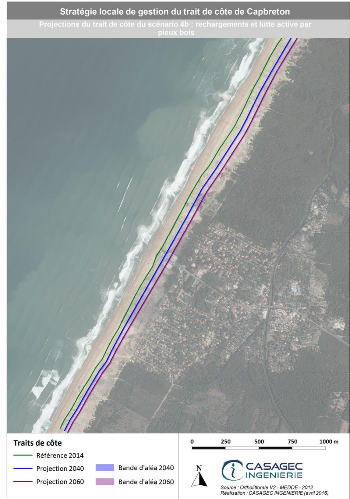
Figure 37. Projection du trait de côte aux horizons 2040 et 2060 pour le scénario 4b. Secteur Labenne.
