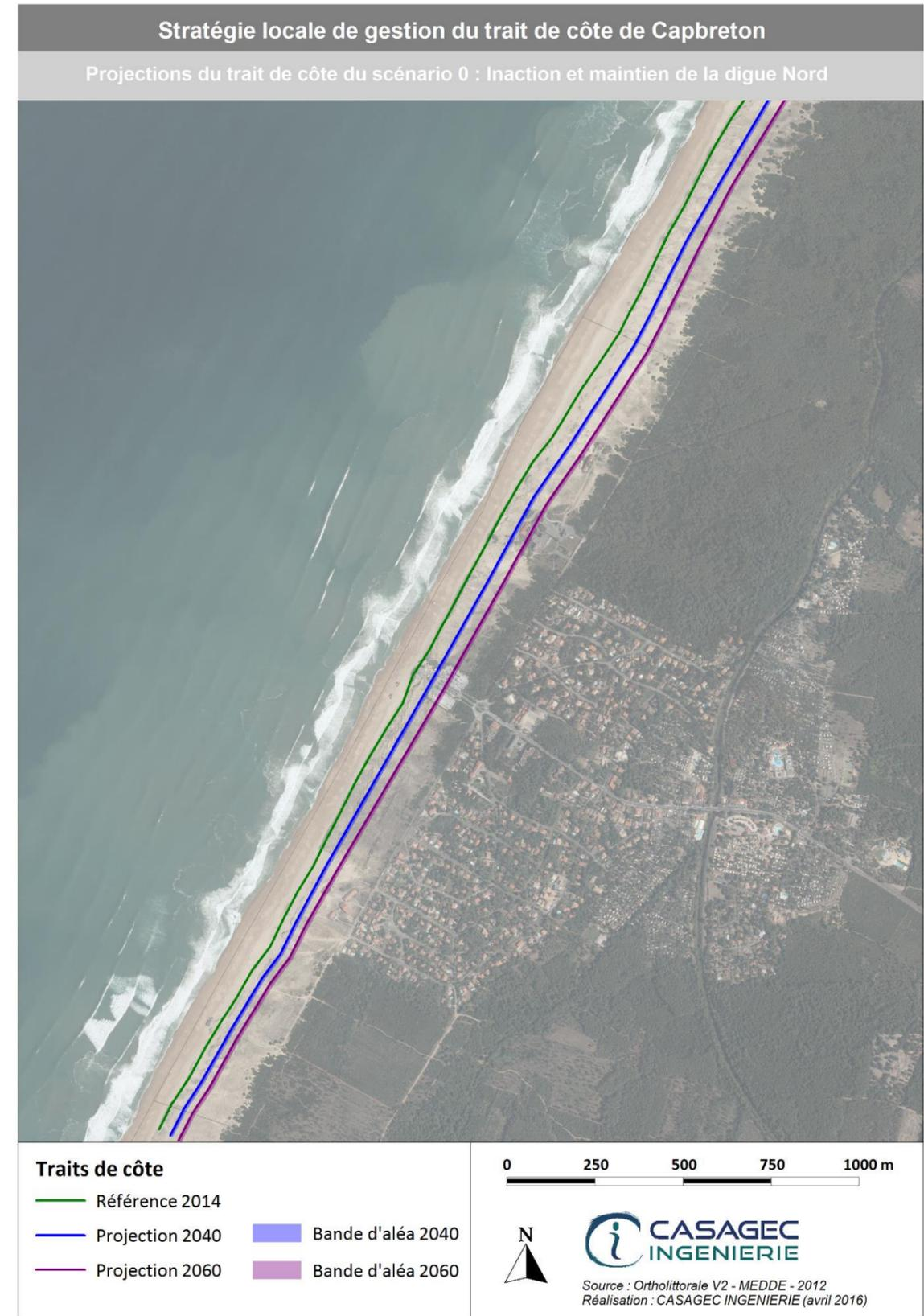
Figure 19. Projection du trait de côte aux horizons 2040 et 2060 pour le scénario 0. Secteur Labenne.
