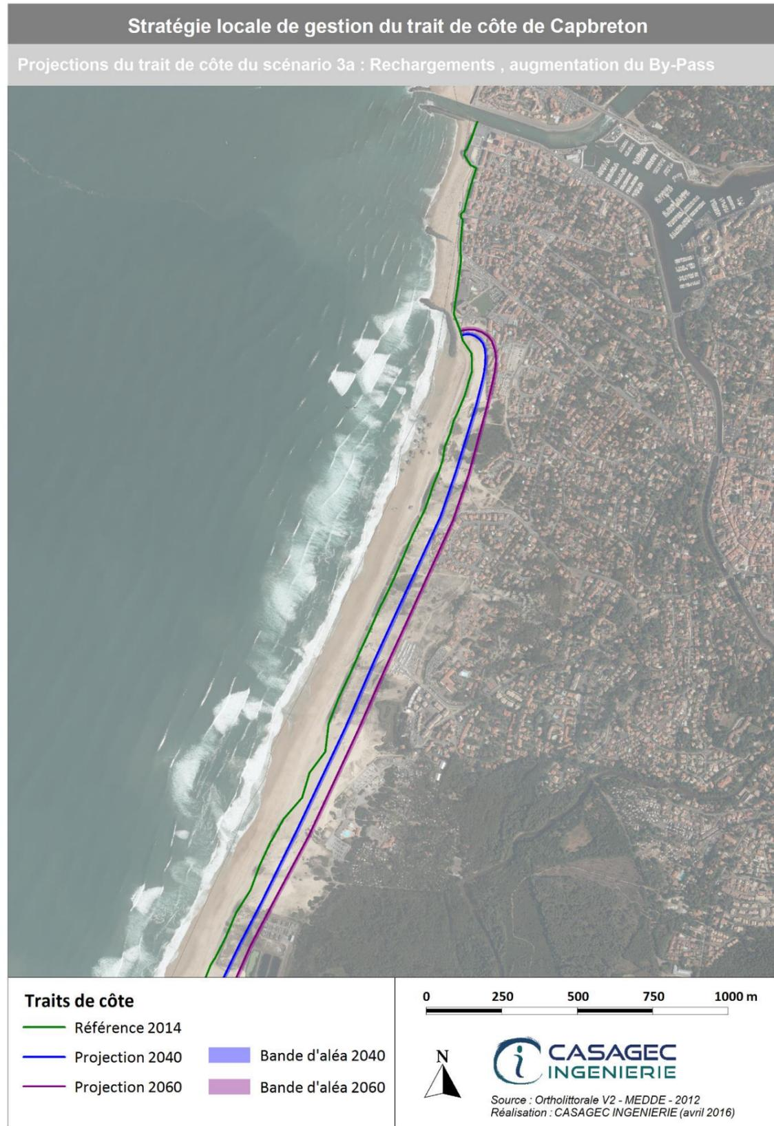
Figure 27. Projection du trait de côte aux horizons 2040 et 2060 pour le scénario 3a. Secteur Capbreton.
