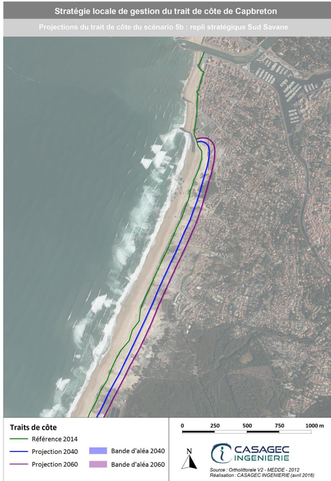
Figure 45. Projection du trait de côte aux horizons 2040 et 2060 pour le scénario 5b. Secteur Capbreton.
