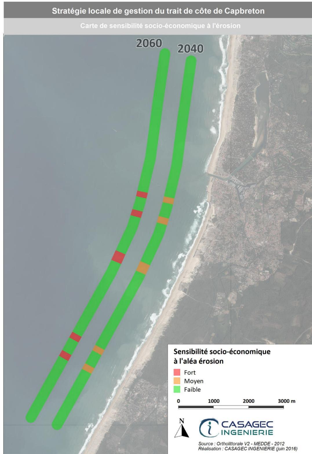
Figure 15. Sensibilité socio-économique du littoral d'Hossegor, Capbreton et Labenne à l'érosion. Horizons 2040 et 2060.
