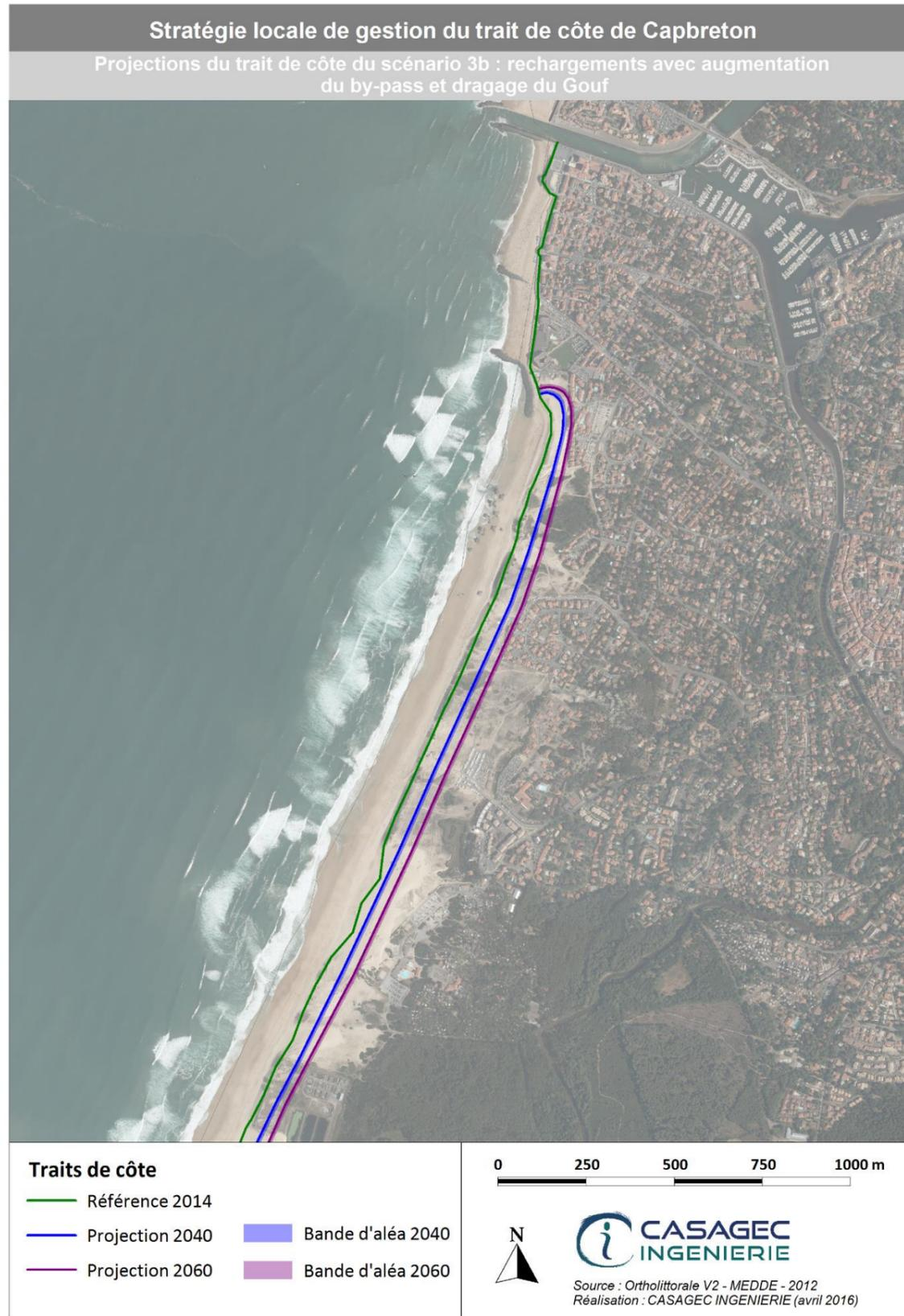
Figure 30. Projection du trait de côte aux horizons 2040 et 2060 pour le scénario 3b. Secteur Capbreton.
