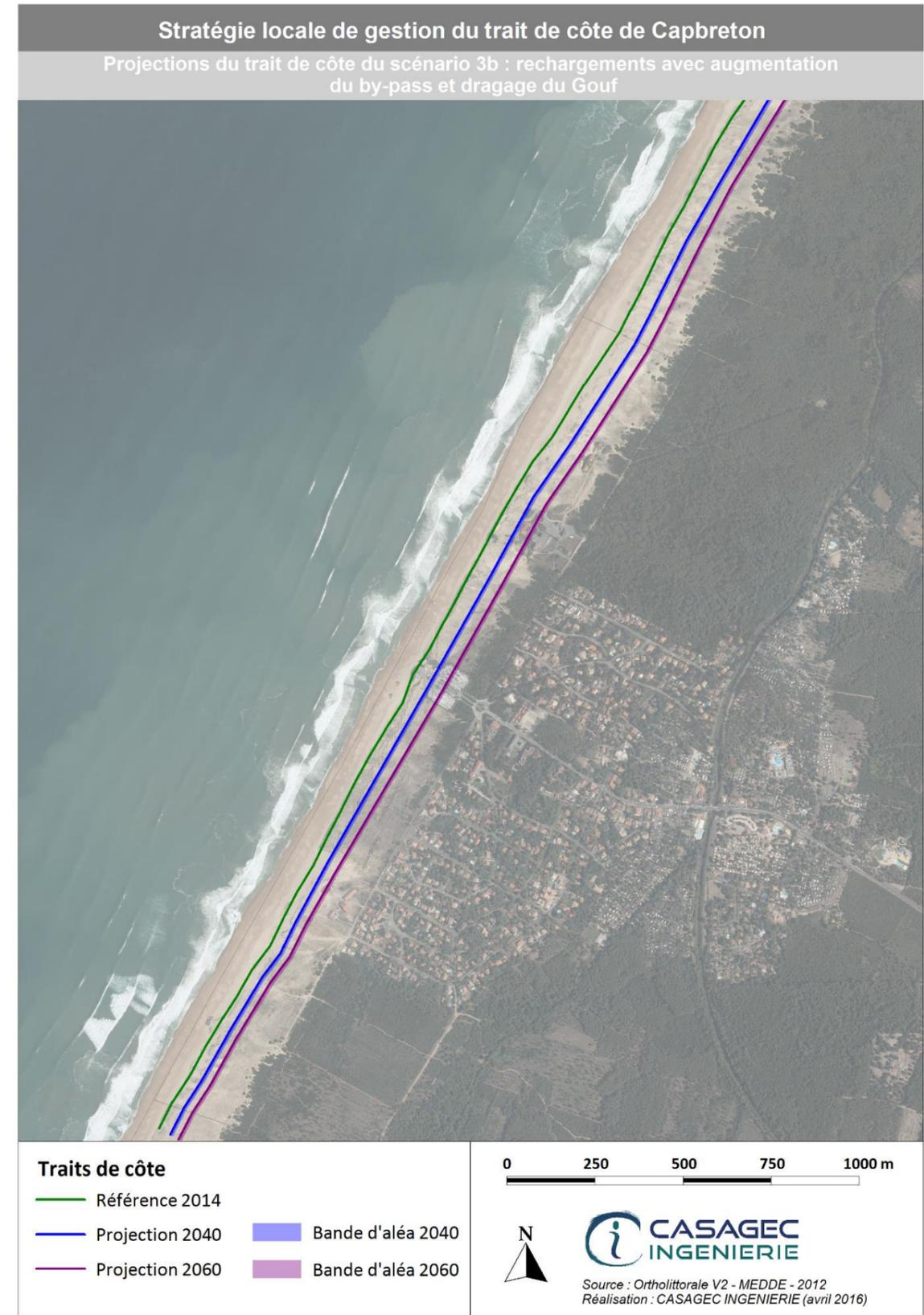
Figure 31. Projection du trait de côte aux horizons 2040 et 2060 pour le scénario 3b. Secteur Labenne.
