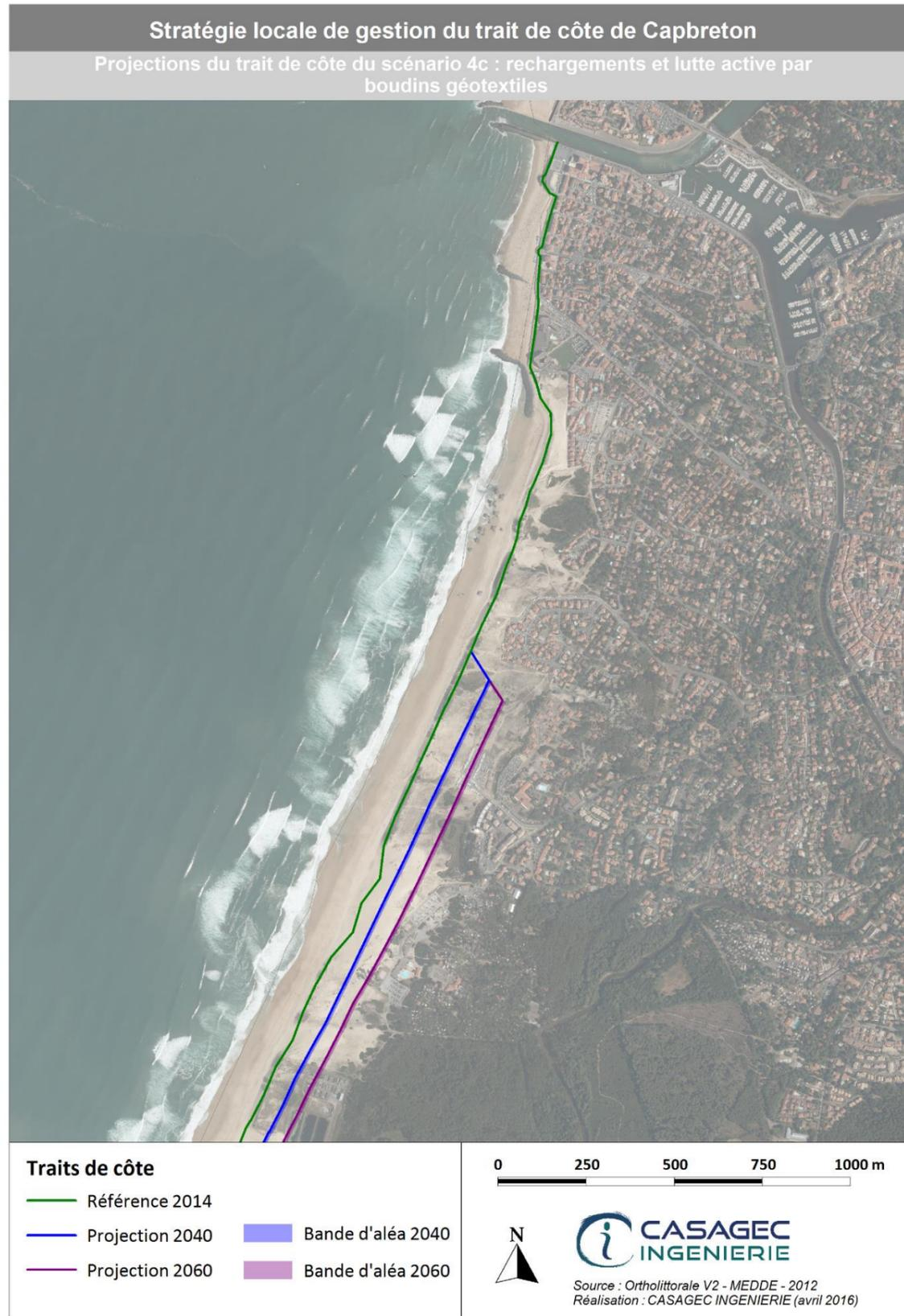
Figure 39. Projection du trait de côte aux horizons 2040 et 2060 pour le scénario 4c. Secteur Capbreton.
