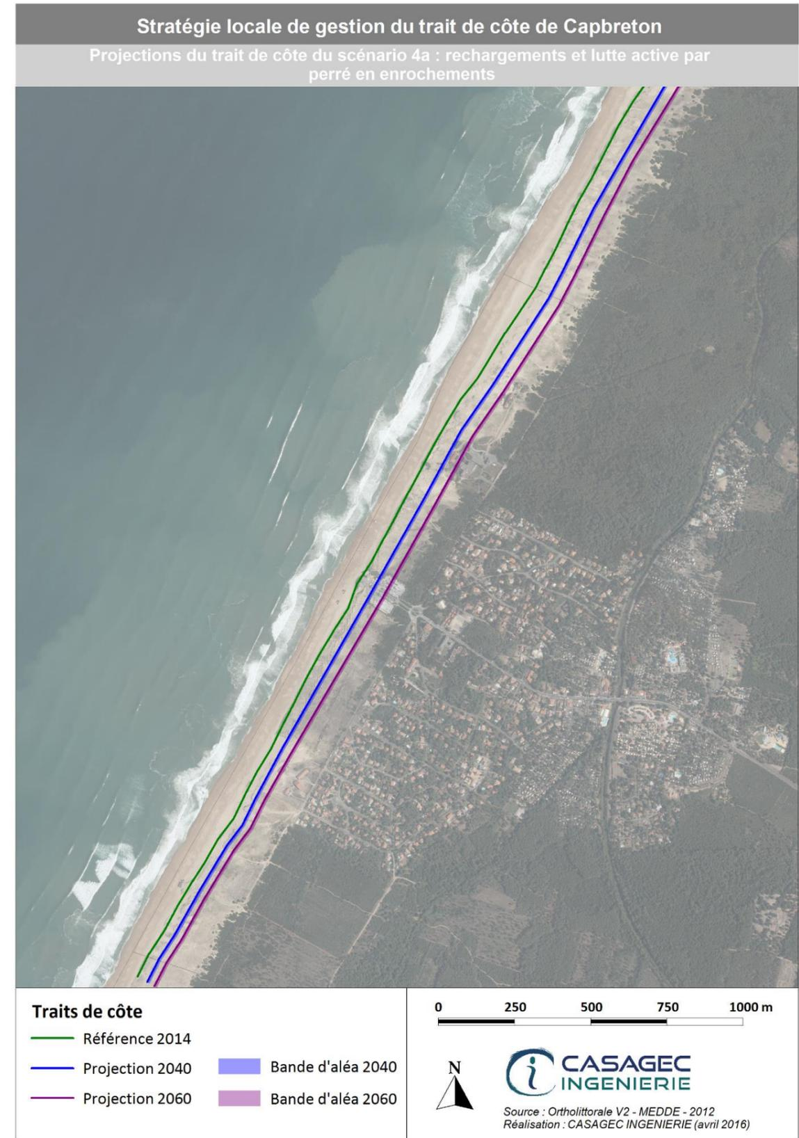
Figure 34. Projection du trait de côte aux horizons 2040 et 2060 pour le scénario 4a. Secteur Labenne.
