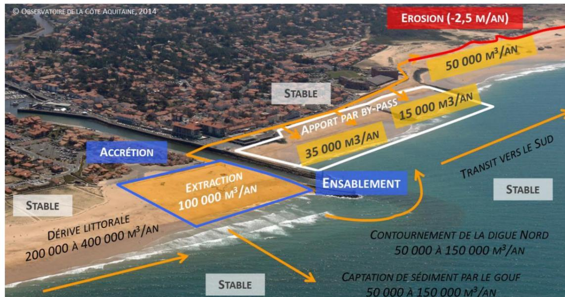
Figure 12. Schéma de fonctionnement hydro-sédimentaire actualisé (source : CASAGEC INGENIERIE, 2015).
